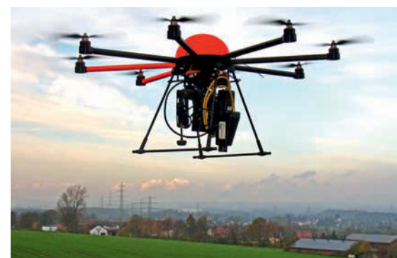
Bild 3: Bei der hyperspektralen Befliegung werden durch die Snapshot Technologie Bewegungsartefakte vermieden und eine WiFi-Verbindung ermöglicht die hyperspektrale Messdatenauswertung bereits während des Fluges
